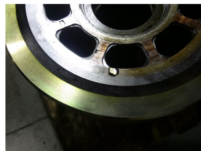
Piattello della pompa con evidenti segni di usura dopo 5000 ore di funzionamento
