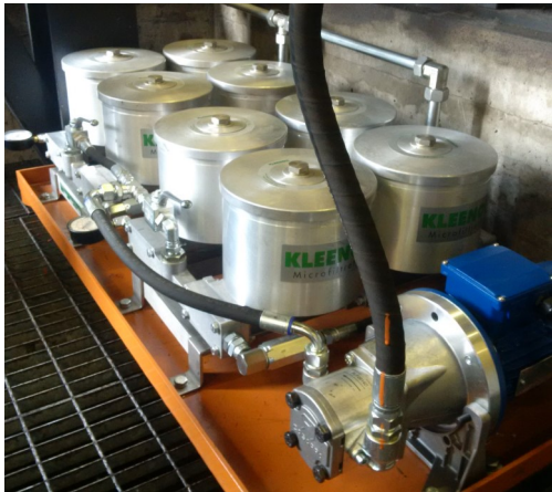
Il sistema di filtrazione KLEENOIL installato con la sua pompa
